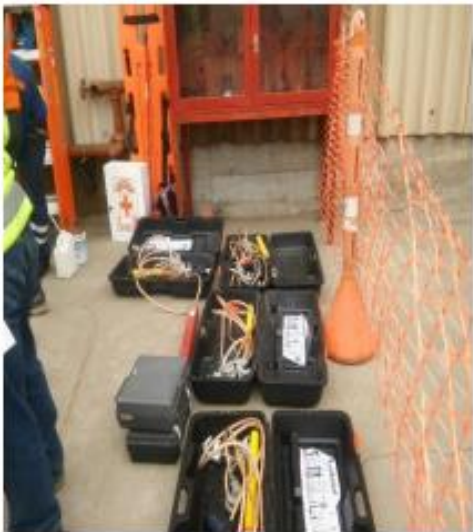
Inspección de kit de puesta a tierra
