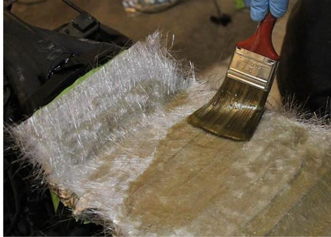
*Figura 8. Aplicación de fibra de vidrio con resina*
