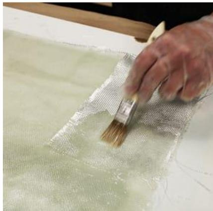
*Figura 9. Aplicación de Tela de vidrio con resina*
